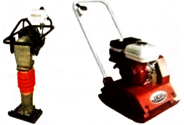
รูปที่ 1.23 เครื่องมือกระทุ้งดินแบบเครื่องยนต์
